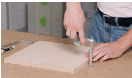
Закрепите заготовку на столе с помощью монтажных струбцин
