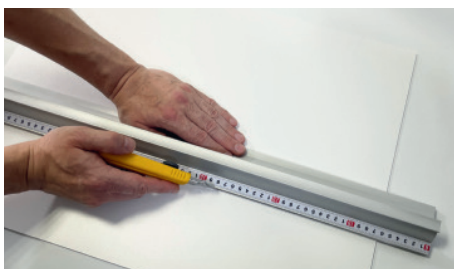
Удобная ручка-держатель позволяет избежать мелких травм и порезов
