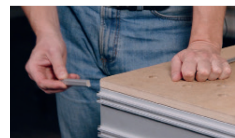
Профиль-ползун PR TR свободно перемещается в боковом пазу стола
