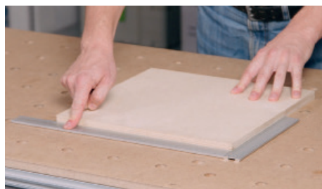
Еще один вариант крепления заготовки с помощью верстачных упоров KT PS
