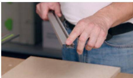
Пазы профиль-упора КТ EM 13 мм
