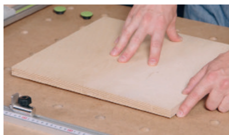
Протекторы приподнимают заготовку над столешницей
