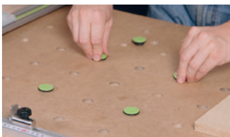
Установите протекторы в отверстия столешницы
